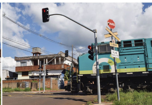
PN Sensoriada 'fecha' o sinal quando o trem está a 400 metros de distância e só abre depois que todo o comboio tiver passado
